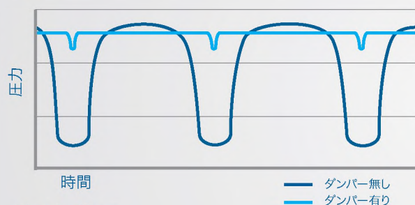
ダンピング効果 ポンプ吐出側の圧力変動をダンパー有りとなしの場合比較
